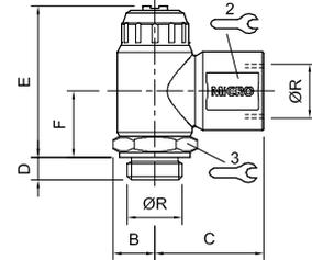
**Regulador de vazão tipo banjo orientável em dois eixos**
