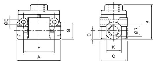
Tipo..... Válvulas de retenção ou anti-retorno séries VA (com bocais rosqueados) ou com conectores instantâneos. São usados para impedir a passagem do ar em um dos sentidos de circulação
