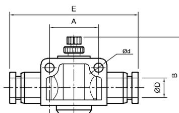
Tipo..... Válvulas de escape rápido séries ERS (com silenciador incorporado) e VA (com escape rosqueado). São usados para aumentar a velocidade de deslocamento dos cilindros
